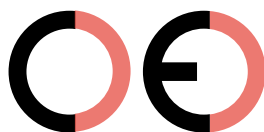
Faux marquage CE (trop éloignée)
